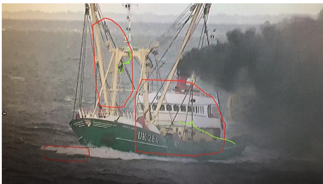
Figuur 17: Binnenlopende viskotter, met een suboptimale verbranding (foto genomen met videocamerasysteem HCC, waardoor er rode en groene lijnen opstaan)
