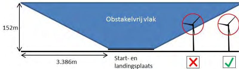
Figuur 1 - Schematische weergave obstakelvrij vlak, zij aanzicht
