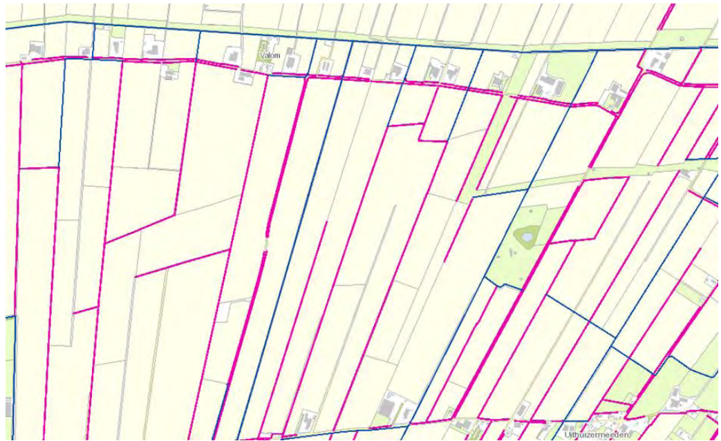
Figuur 16.5: Watergangen in de omgeving van de locatiealternatieven Uithuizerpolder West en Oost. Blauw zijn hoofdwatgangen, roze zijn secundaire watergangen (bron: waterschap Noorderzijvest).
