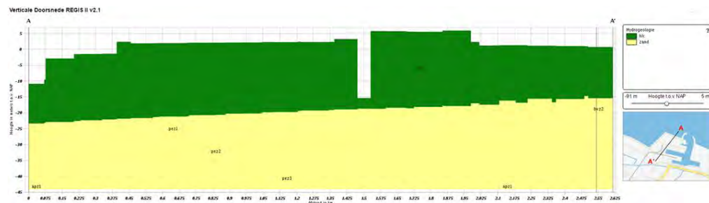
Figuur 16.4: Dwarsdoorsnede Dinoloket TNO met bodemopbouw Eemshaven
