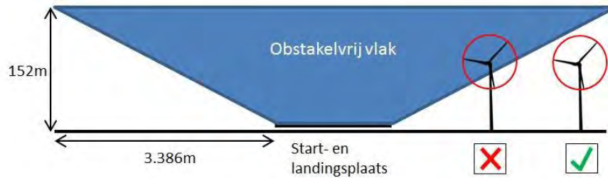
Figuur 4.4: Schematische weergave obstakelvrij vlak, zijaanzicht
