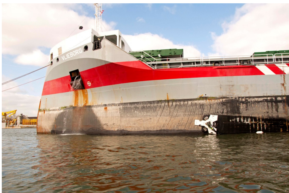
Figuur 12: De Fleetcleaner rijdend over de huid van een schip
